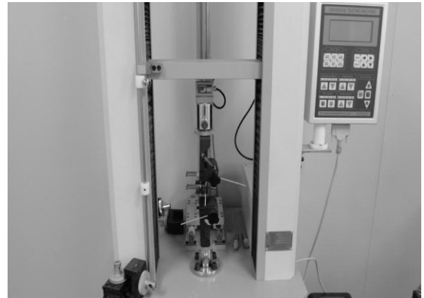
그림1. 아령시험편을 이용한 신율 계산(좌측)과 자사에 보유하고 있는 UTM(Universal Testing Machine)(우측)
